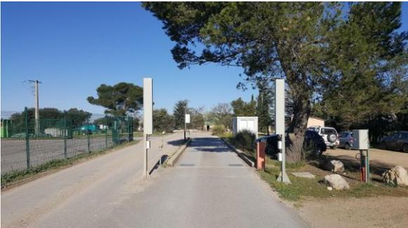
Pont-bascule et portique de détection de la radioactivité
